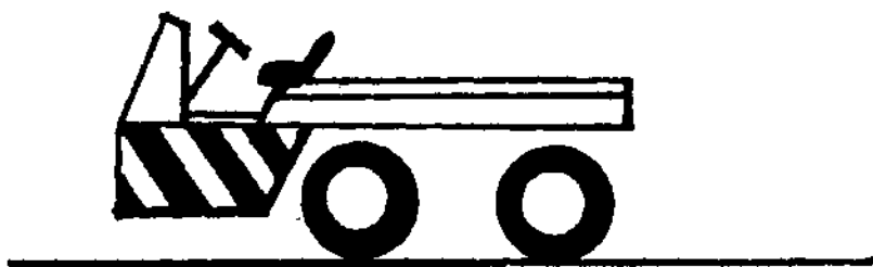
Рисунок 10. Предупреждающая окраска в виде наклоненных чередующихся полос желтого сигнального и черного цветов элементов внутрицехового и межцехового транспорта.
